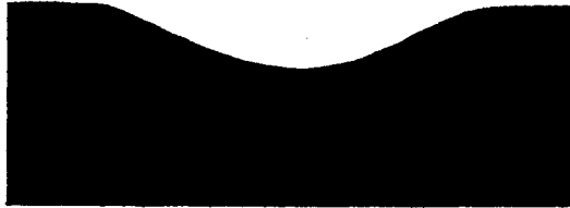
Obr. 3. Profil vyleptaného vzorku při 150násobném zvětšení pod mikroskopem.
