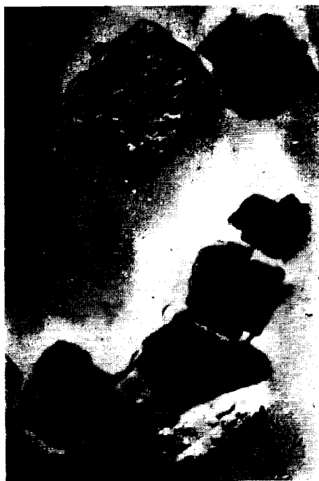
Obr. 16. Mikrofotografie povrchu vzorku práškového \text{ThO}_2 po ohřevu po dobu 5 minut na vzduchu při teplotě 705 °C (a) a 825 °C (b).
