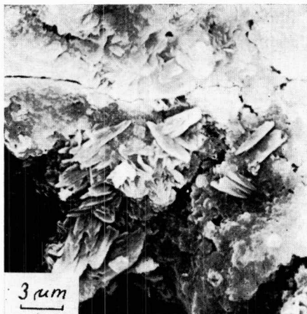
Obr. 5. Korodovaný vzorek pěnobetonu po 60 dnech působení koncentrace 20 % SO 2 a 75 % rel. vlhkosti; difraktograficky identifikován zejména hemihydrát sířičitanu vápenatého. REM.
