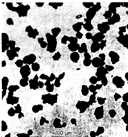
Obr. 5. Mikrofotografia sferoidizovaného gélu ZrO_2 s prídavkom 7 hmot. Y_2O_3 po záhreve pri 1500 °C po dobu 1 h (vzostup teploty 10 K . min -1 ).
